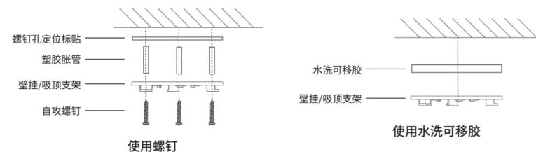
2. 将摄像机固定在壁挂/吸顶支架上。
