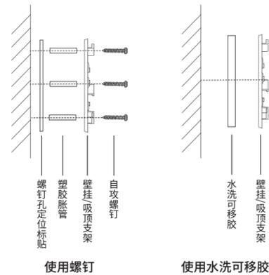
2. 将摄像机固定在壁挂/吸顶支架上。
